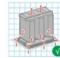
▶ 电抗器应垂直向上安装在通风板上，有利于散热
