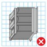
▶ 禁止将电抗器倾斜倒置安装
