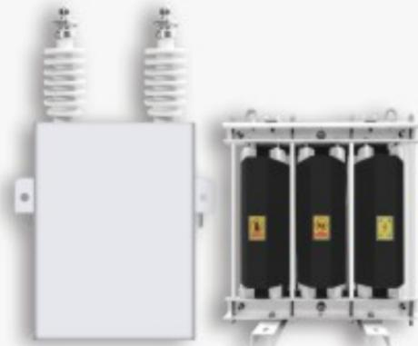
LSDFH型高压无功补偿组件由高压电容器和高压抗谐波电抗器组成滤除特定谐波的补偿回路，抑制电网电压波形畸变，抑制流过电容器组的谐波分量和限制电容器组的合闸涌流。高压补偿组件已经成为无功补偿装置中必不可少的设备。目前在各行业电网建设中，其作为重要的无功补偿设备得到广泛应用。
