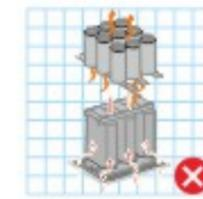
▶ 电容器禁止安装在电抗器的上方
