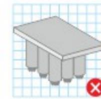
▶ 禁止将电容器垂直反向安装
