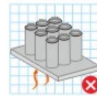
▶ 禁止将电容器安装在无孔的金属板上，不利于通风
