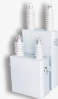
LDHVC型高压电容器使用非氟化物、无毒、可生物降解的浸渍剂，具有非常高的化学稳定性，极高的气体吸收能力和局部放电熄灭能力，每个电容器单元都有内熔丝，用于隔离故障单元；采用双面粗化优质聚丙烯薄膜以保证良好的浸渍，使用寿命长，可用于6KV、10KV系统中滤波补偿、系统电压支撑，释放线路及变压器的能力的作用，降低输电线路和变压器的损耗。
