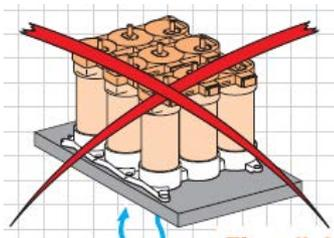
在垂直安装的情况下，禁止将电容器安装在无孔的金属板上：通风不好，电容器会发生危险。
